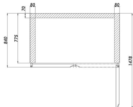
**ISOLATION HAUTE DENSITÉ D'UNE ÉPAISSEUR DE 80 MM**
