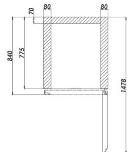
**ISOLATION HAUTE DENSITÉ D'UNE ÉPAISSEUR DE 80 MM**
