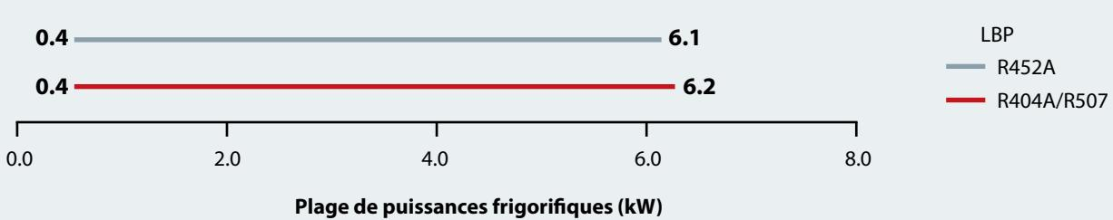
MBP      Conditions nominales, Température d'aspiration saturée -10°C. Température ambiante +32°C. Surchauffe 10K. Sous-refroidissement 0K
