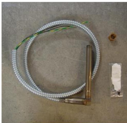
Figure 38 : Kit résistance de carter
